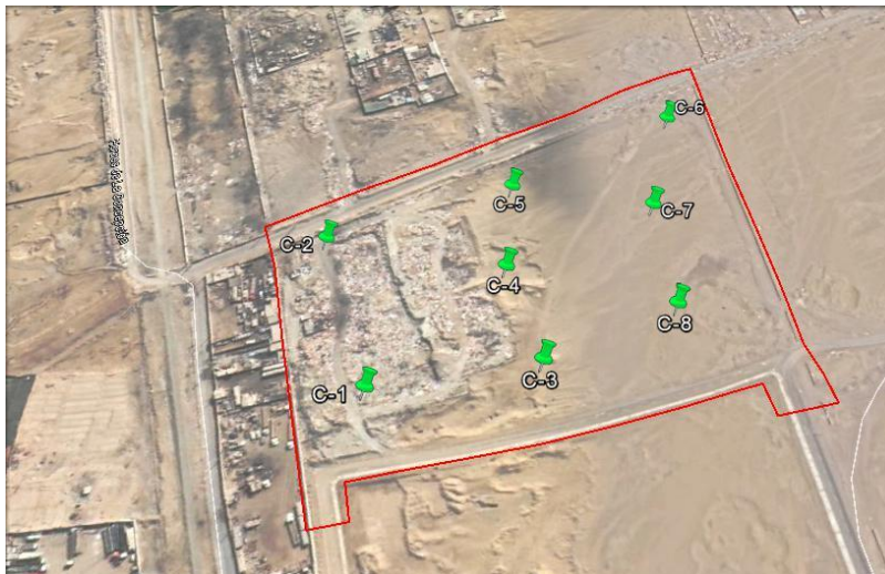
Figura: Ubicación de calicatas
